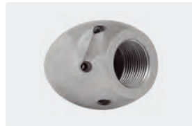
3/4" F. 6x 75° +1x 0°. 30-100 l/min. Pour \text{R} \text{D} 120-250 mm. \text{D} Extérieur 50 mm. \text{P} 567 g.
