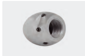
1/2" F. 6x 75° +1x 0°. 30-100 l/min. Pour \text{R} \text{D} 100-200 mm. \text{D} Extérieur 40 mm. \text{P} 281 g.
