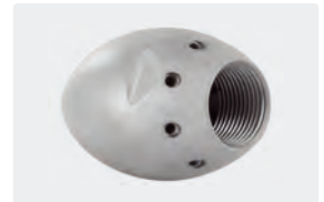
1" F. 8x 75° +1x 0°. 100-250 l/min. Pour \text{R} \text{D} 150-300 mm. \text{D} Extérieur 62 mm. \text{P} 1.265 g.
