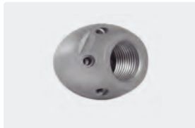
3/8" F. 6x 75° +1x 0°. 25-70 l/min. Pour \text{R} \text{D} 75-150 mm. \text{D} Extérieur 35 mm. \text{P} 207 g.
