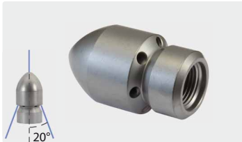
3/8" IG. Außen \varnothing 30 mm. 6 Bohrungen hinten, 1 Bohrung vorn
