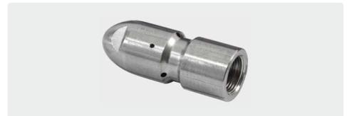
M7 IG. 3 Bohrungen nach hinten für optimalen Vortrieb. Zusätzlich 3 seitliche Bohrungen (90°) für hohe Aufprallkräfte und optimale Wandabdeckung. Außen  $\varnothing$  9,8 mm.
