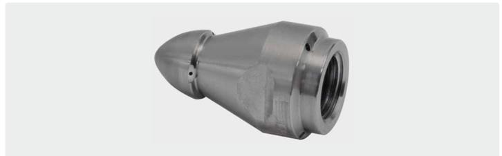
Ausgestattet mit 3 Bohrungen nach hinten (30°) für maximalen Vortrieb und 3 weiteren Bohrungen (45°) direkt hinter der Spitze für ein optimales Reinigungsergebnis ist die Düse besonders für die Entfernung eingewachsener Wurzeln geeignet.
