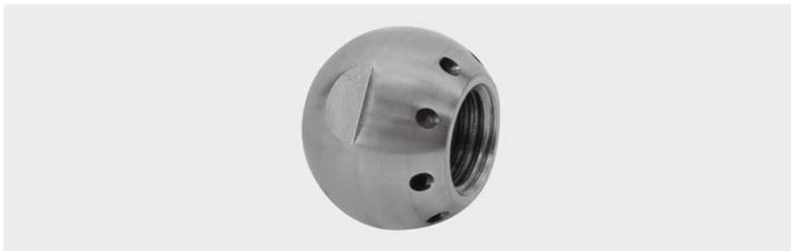
8 Bohrungen 0,6 mm nach hinten für maximalen Vortrieb und ideale seitliche Abdeckung der Rohrwandflächen. Besonders geeignet für öl- und fetthaltige Verschmutzungen sowie Wurzeinwuchs. Komplett kugelförmig Düsenbohrungen vertieft für optimalen Schutz gegen mechanische Beanspruchung.
