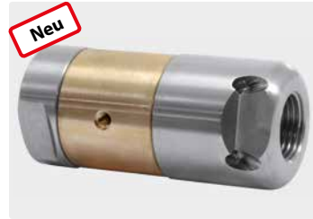
1/2" IG. 5 Bohrungen hinten. 3 Bohrungen seitlich. Außen \varnothing 38 mm. \boxtimes 585 g.
