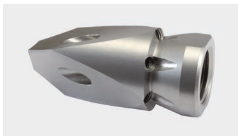
350 bar. 1/2" IG. Für Rohre > 60 mm. Seitliche Frontstrahlen mit gehärteten Edelstahl Düseneinsätzen.
