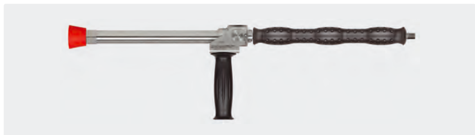
Lance d'hydro-balayage 350 mm acier inoxydable avec manchon ST-29 Cool & Compact 330 mm, poignée latérale et protège-buse en PVC, livrée sans buse. Max. 280 bar / 130 l/min / 100 °C
