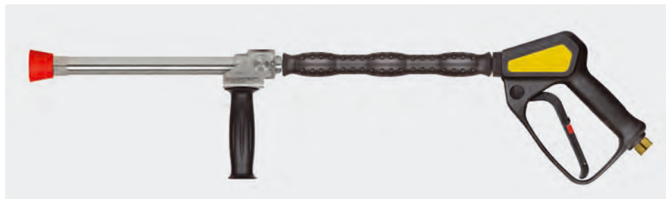
Lance d'hydro-balayage 350 mm acier inoxydable avec manchon ST-29 Cool & Compact 330 mm, pistolet ST-2300, poignée latérale et protège-buse en PVC, livrée sans buse. Max. 280 bar / 45 l/min / 100 °C
