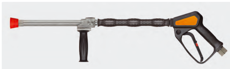
Lance d'hydro-balayage 350 mm acier inoxydable avec manchon ST-29 Cool & Compact 330 mm, pistolet ST-2320, poignée latérale et protège-buse en PVC, livrée sans buse. Max. 150 bar / 80 l/min / 100 °C
