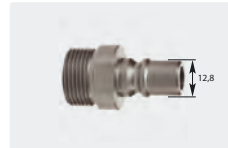
Coupleur mâle : mâle. Inox. Max. 350 bar / 100 °C
