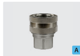
Coupleur femelle : femelle. Laiton cadmié. Max. 250 bar / 150 °C
