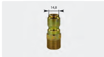
Coupleur mâle : mâle. \varnothing 14,8 mm. Acier zingué. Max. 250 bar / 100 °C
