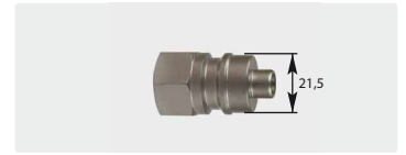
Stecknippel : IG. Gehärteter Edelstahl. Max. 600 bar / 150 °C
