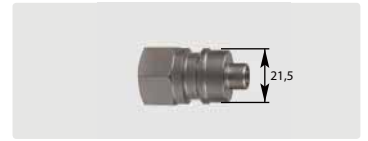
Stecknippel : IG. Gehärteter Edelstahl. Max. 600 bar / 150 °C
