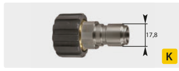
Stecknippel : IG. Edelstahl + Messing. Max. 250 bar / 150 °C
