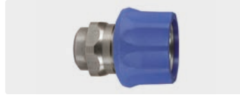
Kupplung : IG. Edelstahl. Max. 250 bar / 150 °C
