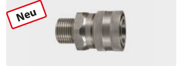
Kupplung : AG. Edelstahl. 60° Dicht- konus. Max. 250 bar / 150 °C
