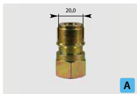
Штекер : IG. Оцинк. сталь. Макс. 250 bar / 150 °C
