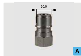
Штекер : IG. Закаленная нерж. сталь. Макс. 250 bar / 150 °C
