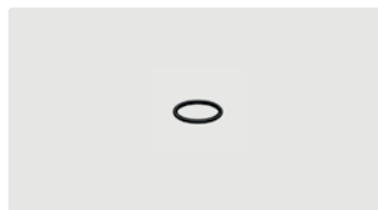
O-ring. TYP SP-20. 13.1x2.6. Max. 150 bar / 100 °C
