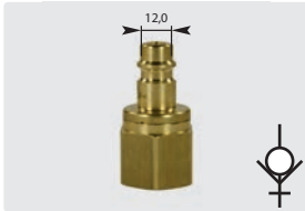
Stecknippel : IG. \varnothing 12 mm. Messing. Mit Ventil. Max. 35 bar / 100 °C
