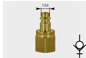
Stecknippel : IG. Ø 12 mm. Messing. Mit Ventil. Max. 35 bar / 100 °C
