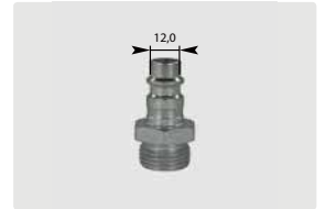
Stecknippel : AG. Ø 12 mm. Stahl vernickelt. Max. 250 bar / 100 °C
