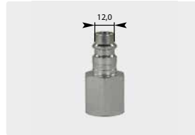
Stecknippel : IG. Ø 12 mm. Stahl vernickelt. Max. 250 bar / 100 °C
