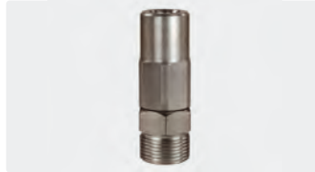
1/4" F : M22 M. Inox. Raccord tournant avec roulement radial. Max. 350 bar / 90 °C
