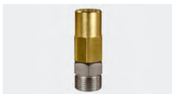
1/4" F : M22 M. Inox / laiton. Raccord tournant avec roulement radial. Max. 350 bar / 90 °C
