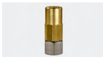
1/4" F : 3/8" F. Inox / laiton. Raccord tournant avec roulement radial. Max. 350 bar / 90 °C
