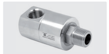
DGEI 90°. Gehäuse Edelstahl. 3-fach gelagert. Max. 350 bar
