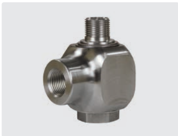
3/8" F : 3/8" M. DN 10. Max. 400 bar / 30 r.p.m. / 90 °C
