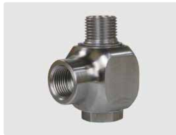
1/2" F : 1/2" M. DN 12. Max. 300 bar / 30 r.p.m. / 90 °C
