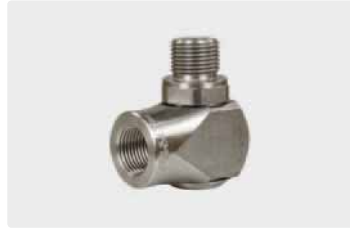
3/8" F : 3/8" M. Max. 400 bar / 30 r.p.m. / 90 °C
