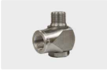
3/8" F : 3/8" M. Max. 400 bar / 30 r.p.m. / 90 °C
