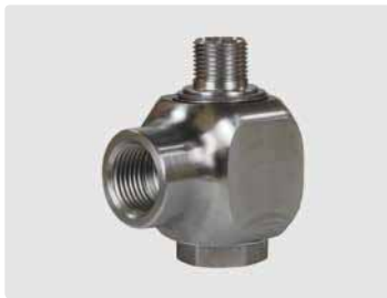
1/2" F : 3/8" M. DN 10. Max. 300 bar / 30 r.p.m. / 90 °C
