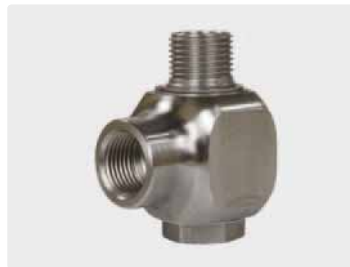
1/2" F : 1/2" M. DN 12. Max. 300 bar / 30 r.p.m. / 90 °C
