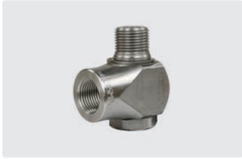
3/8" F : 3/8" M. Max. 400 bar / 30 r.p.m. / 90 °C
