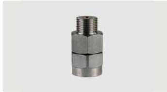
3/8" AG : 3/8" IG. Edelstahl. Max. 500 bar / 90 °C
