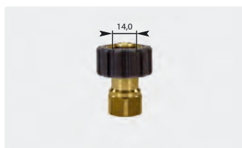
Standard M22 : femelle. Noir. Max. 400 bar / 150 °C
