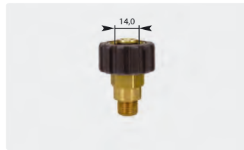
Standard M22 F : mâle. Noir. Max. 400 bar / 150 °C
