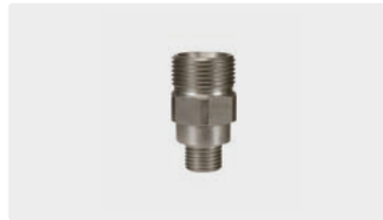
M22 AG : 1/4" AG. Langbohrung. Max. 400 bar / 150 °C
