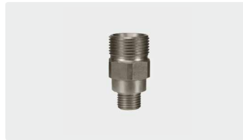
M22 AG : 1/4" AG. Langbohrung. Max. 400 bar / 150 °C
