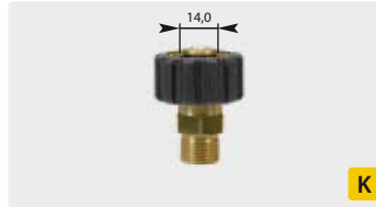
M22 F : M. Max. 400 bar / 150 °C
