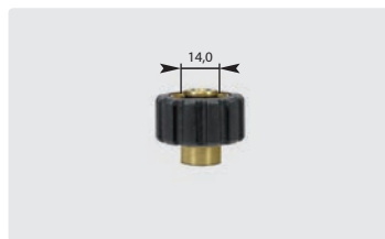
Kurz M22 : IG. Schwarz. Max. 400 bar / 150 °C
