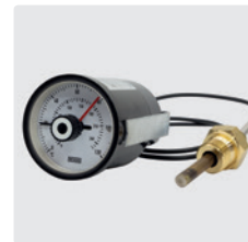
1/2" AG. Kontakt 5 A - 250 V (AC1). Temperaturanzeige 0 - 120 °C
