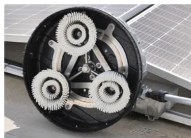
**Три вращающихся щеток:** гидропривод благодаря тройному роторному кронштейну, который также оснащен креплением из нержавеющей стали.
