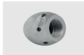
1/2" IG. 6x 75° +1x 0°. 30-100 l/min. Für \text{R} \text{Ø} 100-200 mm. Außen \text{Ø} 40 mm. \text{g} 281 g.
