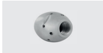
3/8" IG. 6x 75° 3x 30° +1x 0°. 30-100 l/min. Für \text{R} \text{Ø} 100-200 mm. Außen \text{Ø} 35 mm. \text{g} 314 g.
