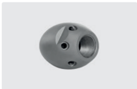
1/4" IG. 6x 75° +1x 0°. 20-50 l/min. Für \text{R} \text{Ø} 50-100 mm. Außen \text{Ø} 30 mm. \text{g} 127 g.
