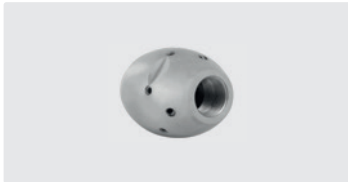
1/4" IG. 6x 75° 3x 30° +1x 0°. 25-70 l/min. Für \text{R} \text{Ø} 75-150 mm. Außen \text{Ø} 30 mm. \text{g} 223 g.
