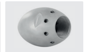
1" IG. 8x 75° +1x 0°. 100-250 l/min. Für \text{R} \text{Ø} 150-300 mm. Außen \text{Ø} 62 mm. \text{g} 1.265 g.
