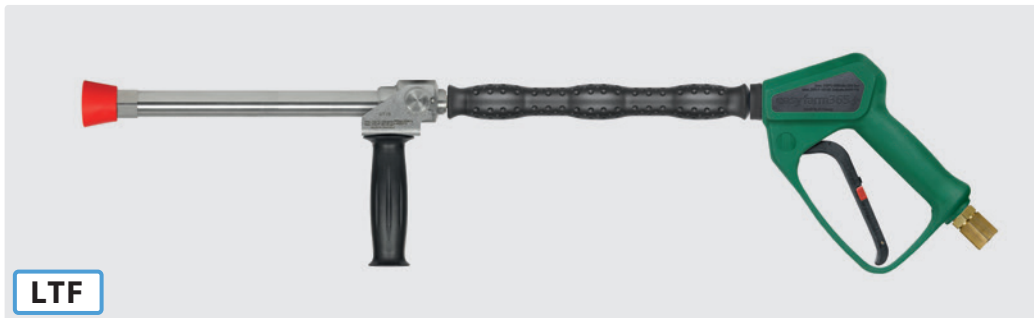
1/2" IG. Edelstahl. Weitwurf lance 350 mm mit Isolierung ST-29 Cool & Compact 330 mm, Pistole easyfarm365+, seitlichem Handgriff und Düsenschutz aus Kunststoff ohne Düse. Max. 250 bar / 60 l/min / 100 °C
