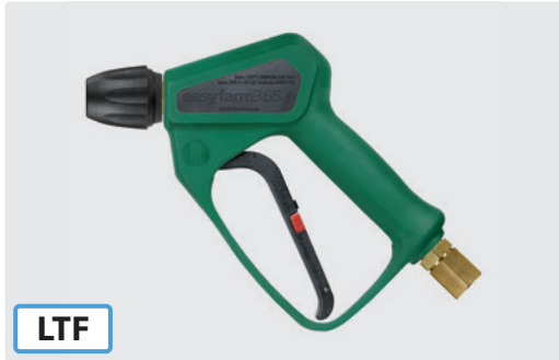
Professionelle Pistole mit Kupplung KW. Max. 250 bar / 60 l/min / 150 °C
