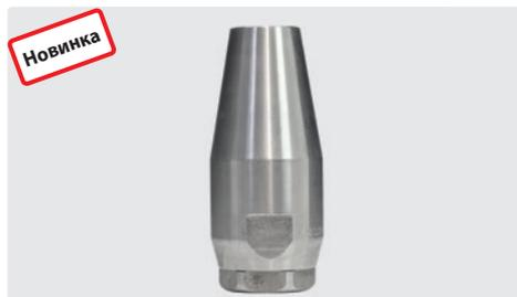
Нерж. сталь. 1/4" IG. Роторная форсунка с одной вращающейся фронтальной, с 5 до 8 прецизионных отверстий 0,4 мм для направленных назад толкающих струй. Max. 275 bar / 150 °C
