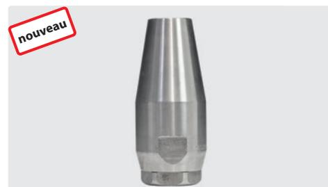
Acier inoxydable. 1/4" F. Rotabuse avec 1 jet frontal rotatif, 5 à 8 alésages de précision de 0,4 mm pour les jets rétroactifs.
