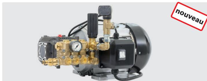
400 Volts. Toutes les versions sont équipées d'une vanne by-pass intégrée, d'une commande stop-total temporisée, d'un contrôleur de débit ST-7, d'un manomètre, d'un câble d'alimentation électrique de 5 m et d'un disjoncteur marche/arrêt. Entrée 1/2" M et nez de robinet „Universel“, sortie HP 3/8" M. Température max. 40 °C.
