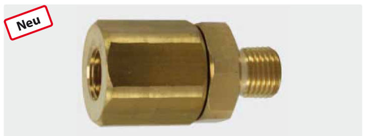
Messing mit Edelstahlsieb. Bidirektional einsetzbar. Max. 400 bar / 40 l/min. / 150 °C
