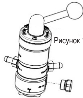
Воздушный обратный вентиль ST-164 (Артикул-Nr. 20 0164 370)
