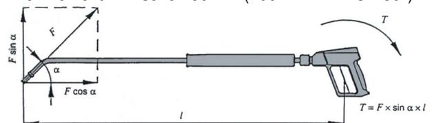
**Diagramm zum Ermitteln der Düsendgröße nach DIN EN 60335-2-79**
