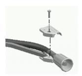
Um die Kunststoffabdeckung zu entfernen, lösen Sie die Kreuzschlitzschraube.
