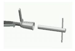
Lösen Sie die vorhandene Düse mit einem passenden Düsenschlüssel. Damit sich der Schlauch nicht verdreht, kontern Sie an der Düsenschutzmuffe mit einem Maulschlüssel (SW 17). Schrauben Sie die neue Düse ein. Entlasten Sie dabei ebenfalls den Schlauch durch Kontern. Bringen Sie die Kunststoffabdeckung wieder an.
